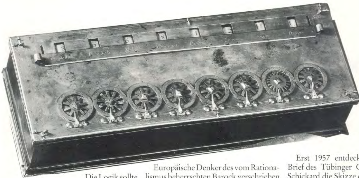
Nachbildung der Rechenmaschine Blaise Pascals von 1642. Mit seiner Erfindung hatte Pascal das Addieren mechanisiert. Er wollte seinem Vater Étienne Pascal die nächtelangen Rechnereien ersparen, die mit der Arbeit als Steuerintendant verbunden waren.
